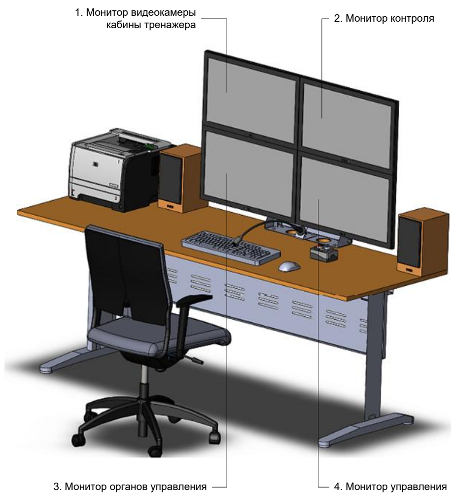
Рисунок 1 – Расположение мониторов модуля инструктора
